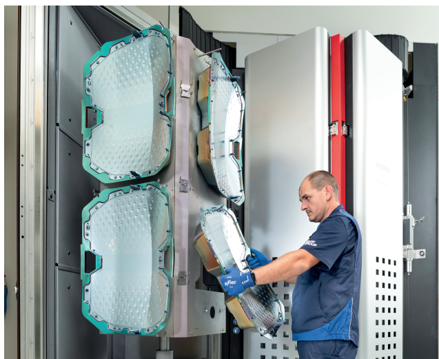
Sichtkontrolle nach PVD-Beschichtung der Frontniere des BMW iX. © BMW
